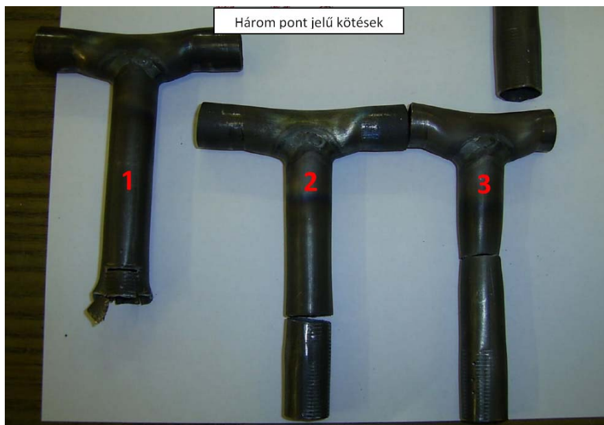
19. ábra Racer U96 / 02 vizsgálat szakadási töretei
