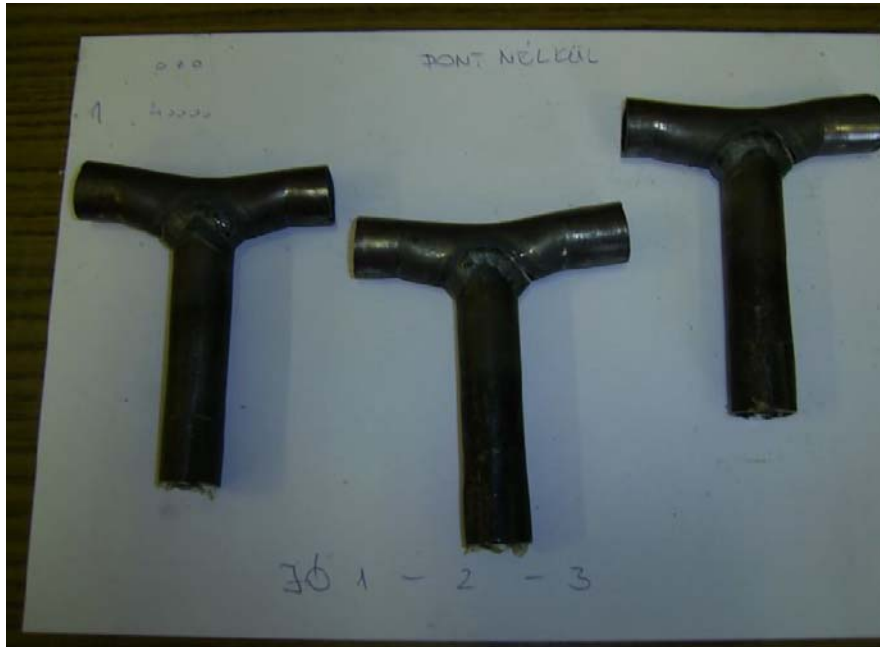
20. ábra Racer 1.7734 / 01 vizsgálat szakadási töretei
