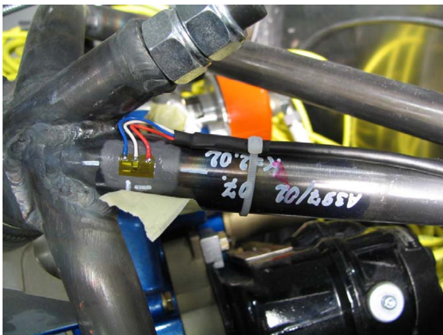
16. ábra A motortartó bakon elhelyezett nyúlásmérő bélyeg
