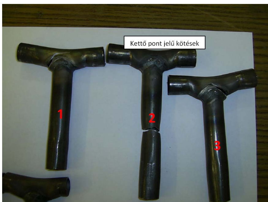
18. ábra Racer U96 / 01 vizsgálat szakadási töretei
