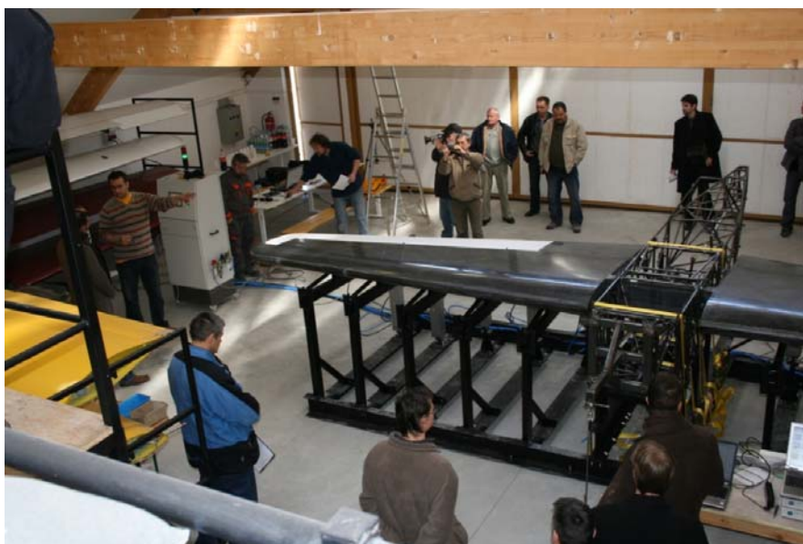
13. ábra A Racer szilárdsági vizsgálata
