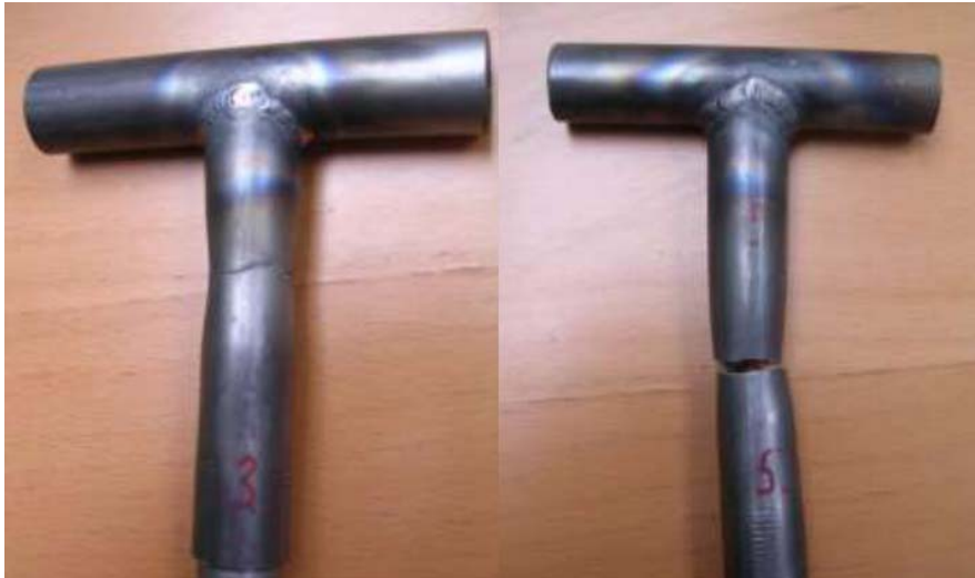
21. ábra Racer 1.7734 / 02 vizsgálat szakadási töretei
