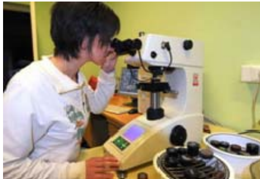
6. ábra Hőhatásövezet vizsgálata
