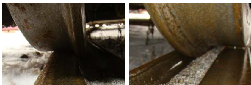
2. ábra A külső (balra) és a belső (jobbra) íven futó kerék elhelyezkedése a sínhoronyban és a sín oldalfalához képest
