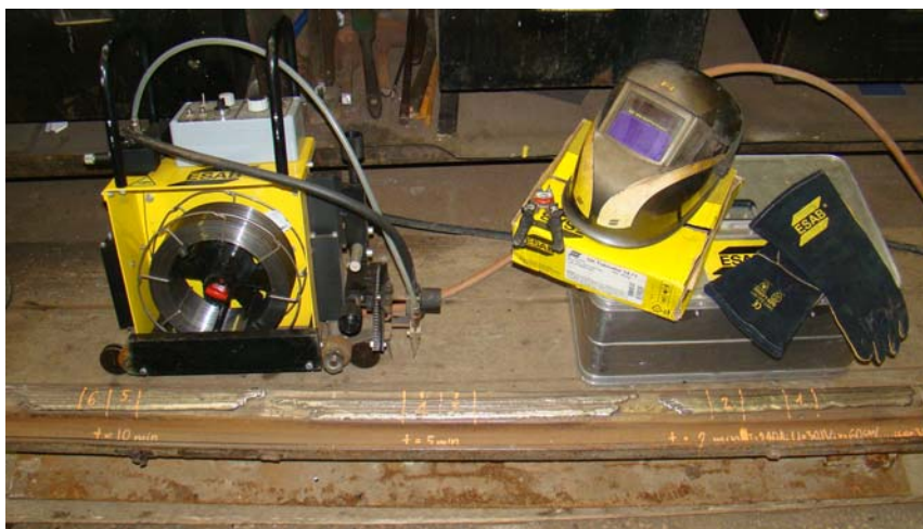
9. ábra A felrakott futófelületű Phoenix sín. (Jobbról balra sorban a 2, 5 és 10 perces ciklusidővel elkészített varratok)
