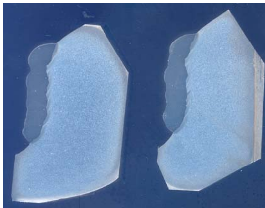
11. ábra Phoenix sín oldalfal felrakóhegesztés keresztmetszeti csiszolata. (A sín talpa, gerince, hornya és a sínfej jelentős része el lett távolítva a könnyebb kezelhetőség érdekében.)
