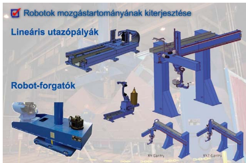
1. ábra Hegesztőrobot munkaterének kiterjesztése nagyméretű munkadarabok hegesztéséhez
