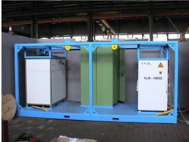
14. ábra 10kW szállézer mobil egység
