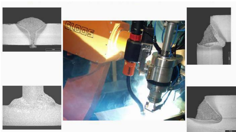
10. ábra Tompa és sarokkötések lézer – hibrid eljárással történt kivitelezésére
