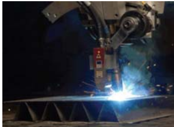
9. ábra Szendvics panel lézer-hibrid hegesztése
