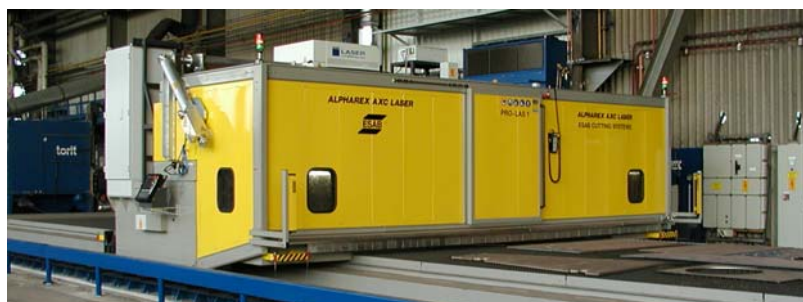
2. ábra. Alpharex AXD lézer vágó és hegesztő berendezés a Prolas lézersugár biztonsági rendszerrel
