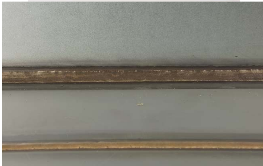
9. ábra 1mm vastag horganyzott lemezek CMT forrasztása, 1,1 m/perc hegesztési sebességgel
