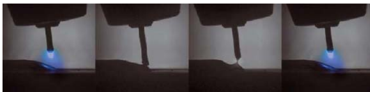
7. ábra A CMT ciklus fázisai (a harmadik képen látható fázisban történik a huzal visszahúzása)
