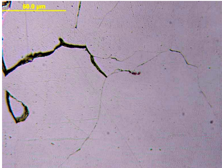
6. ábra A forrasanyag-behatolás az acél szemcsehatárai mentén a felülethez közel
