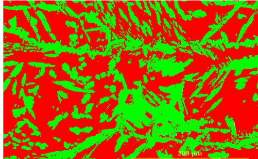
4. ábra. A varratfém koronaoldala és a képelemzővel elkülönített fázisok (piros=ferrit)
