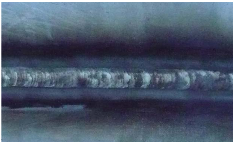
14. ábra Az olajos felületek hegesztésénél látható kormos varrat felszín
