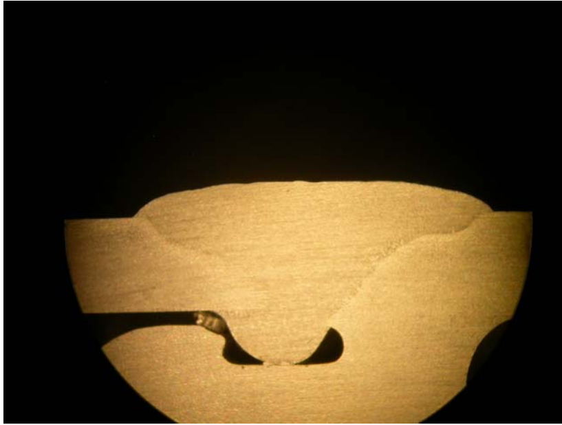
27. ábra 30% héliumot és 70% argont tartalmazó védőgázzal hegesztett varrat
