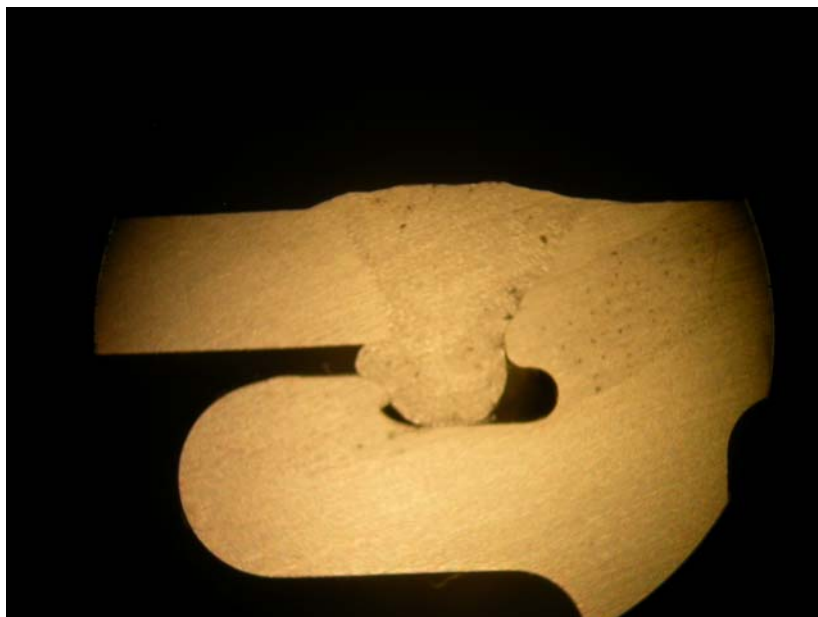
24. ábra 4.6-os tisztaságú argonnal készített varrat
