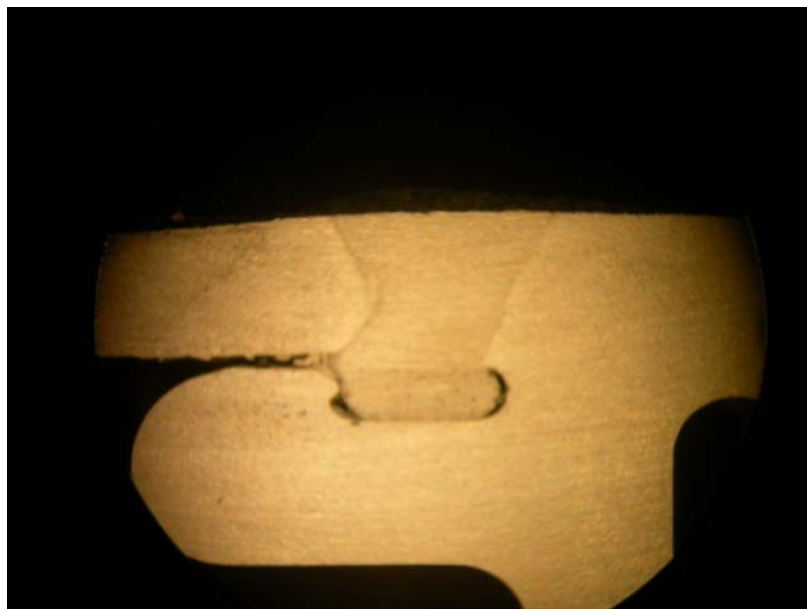
15. ábra Párás felületen hegesztett varrat
