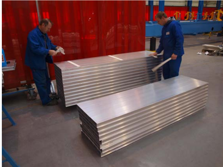
5. ábra Alumínium profilok tisztítása, jól láthatók a tárolás során a szellőző rést biztosító kartoncsíkok
