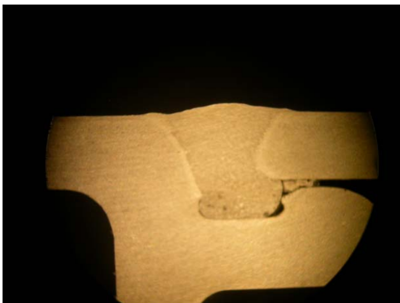
12. ábra A kéz nedvességével és zsírosságával szennyezett felületek hegesztése
