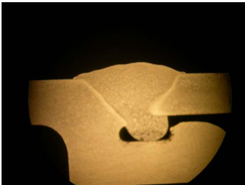
9. ábra Csökkentett (9 l/min) védőgáz térfogatárammal készített varrat
