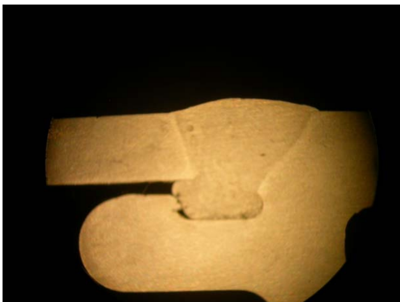
13. ábra Olajjal szennyezett felületek hegesztése
