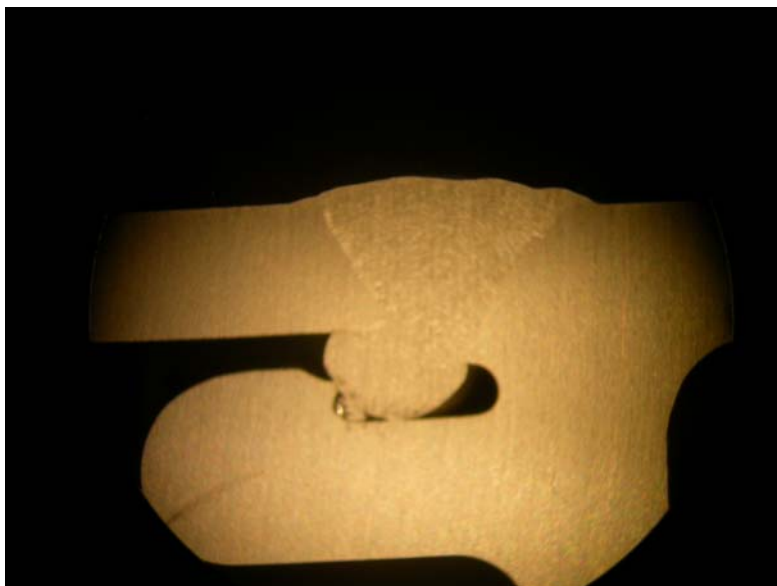
17. ábra 0 °C-os próbadarab hegesztése
