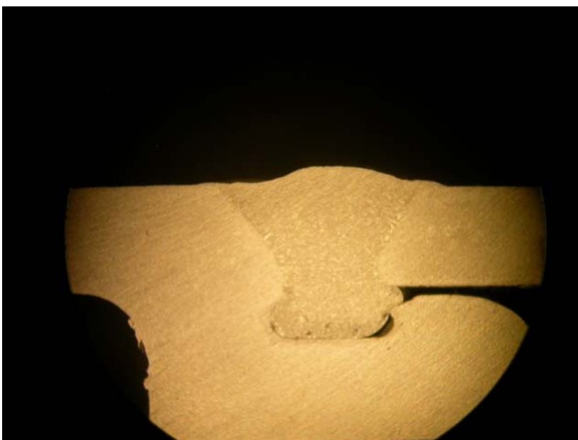
26. ábra 10% héliumot és 90% argont tartalmazó védőgázzal hegesztett varrat
