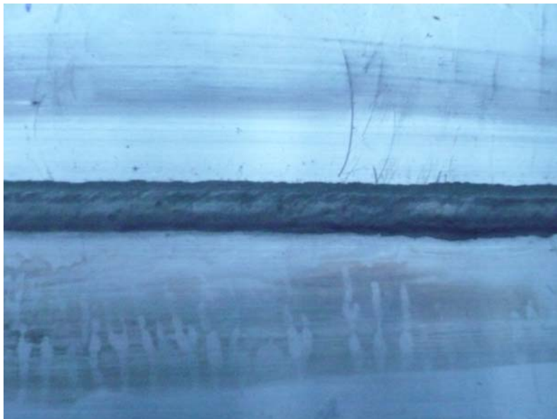
20. ábra Húzott pisztollyal készített varrat felszíne a tisztítás után
