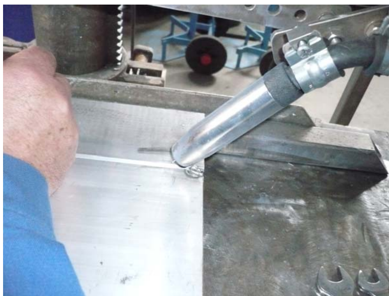
7. ábra A hegesztő-pisztolyfej és a próbadarab
