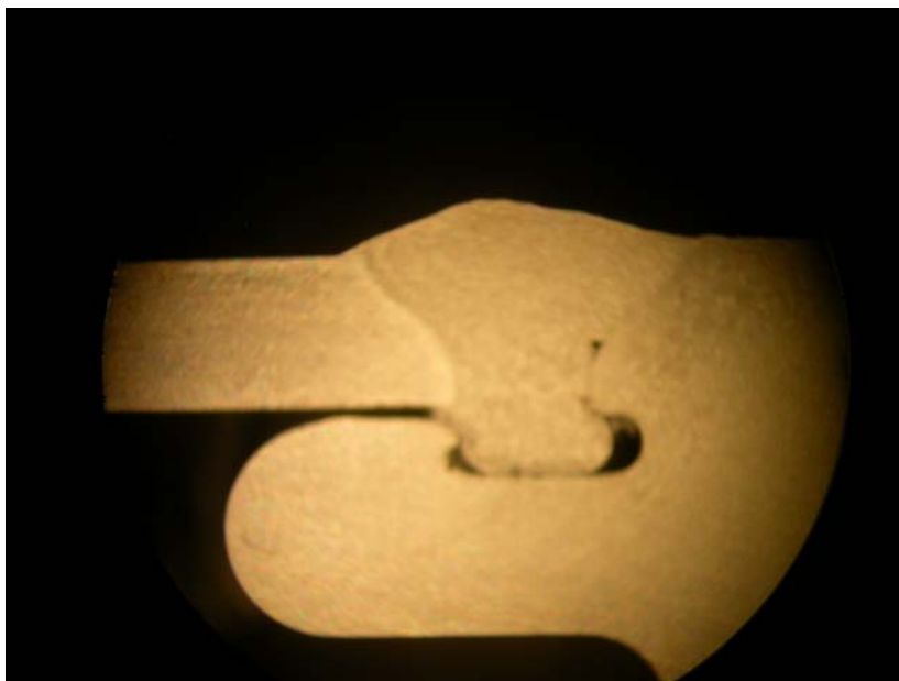
11. ábra Növelt (25 l/min) védőgáz térfogatárammal készített varrat
